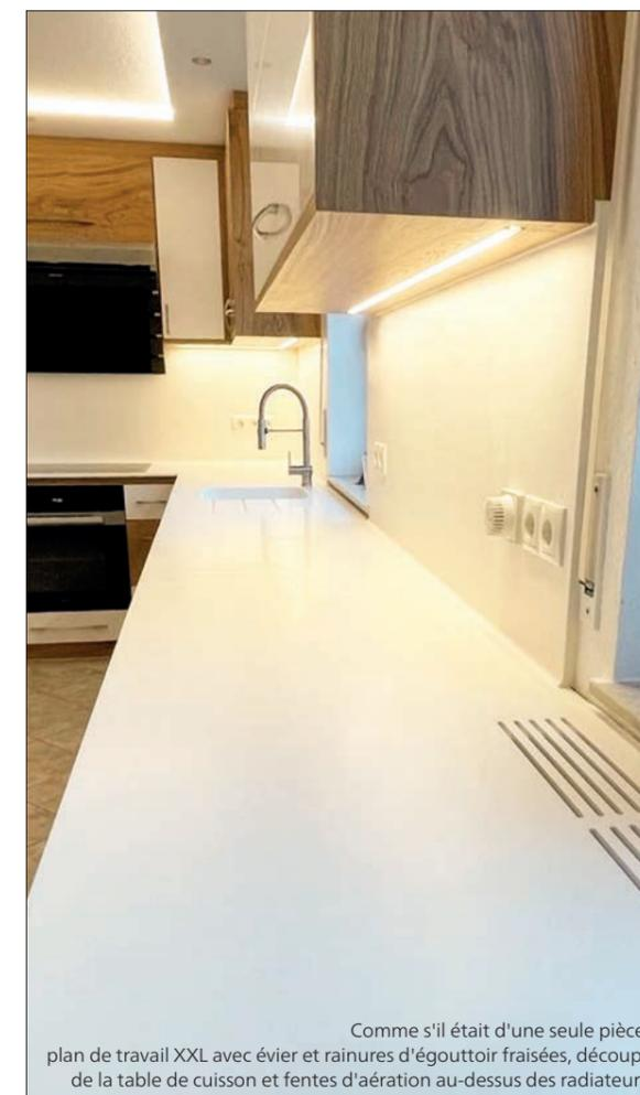
Comme s'il était d'une seule pièce : plan de travail XXL avec évier et rainures d'égouttoir fraisées, découpe de la table de cuisson et fentes d'aération au-dessus des radiateurs.
